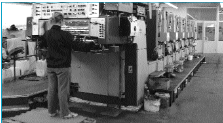
Серце будь-якої друкарні — друкарська машина. Офсетна листова 6-секційна друкарська машина.
